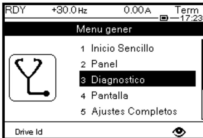
2. En el sub menú Diagnostico podemos navegar por: Datos Diagnostico, Errores y Advertencias mediante las teclas físicas del HMI.
